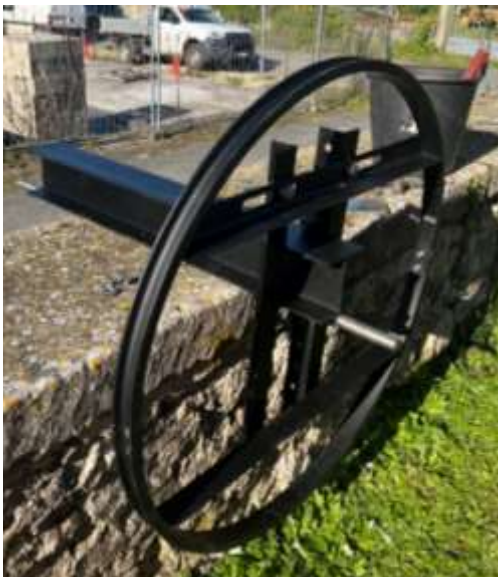
Figure 6 : Le nouveau joug flambant neuf encore au sol... (Ph. MBG)
